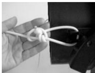
Fissaggio alla maniglia destra, con nodo regolabile.
