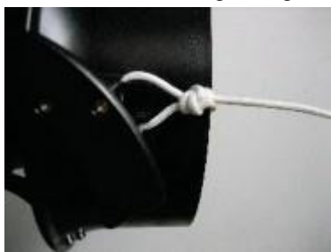
Fissaggio della fune alla maniglia sx
